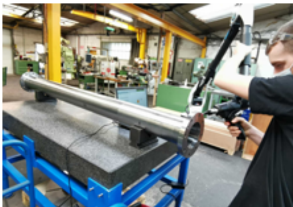
Le contrôle dimensionnel, ici d'une tuyauterie, permet de détecter les éventuels écarts et de les traiter.
